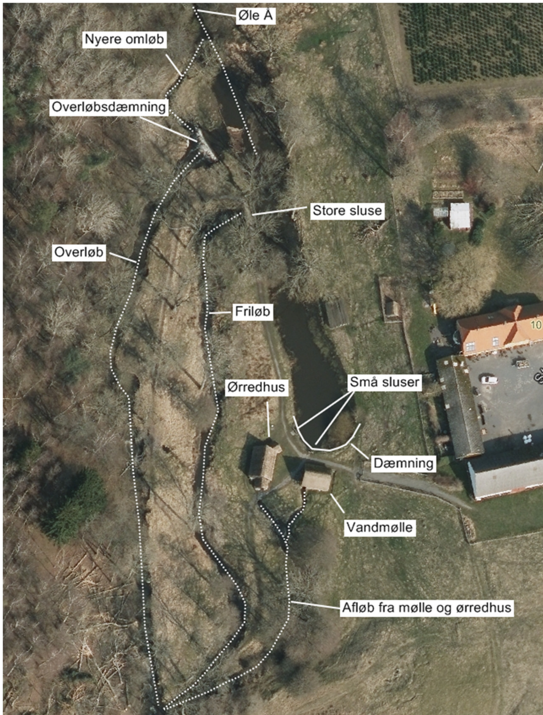
Oversigt over anlægget
